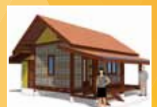
ภาพแสดง การออกแบบ แสดงการใช้ประโยชน์จาก แผ่นผนังใบตาลโดนดมา ก่อสร้างเป็นบ้านขนาดเล็ก
