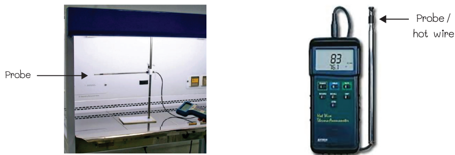
รูปที่ 26 การติดตั้งอุปกรณ์ Thermal anemometer และ Probe ใช้วัดความเร็วลมภายในตู้ (ที่มา : www.afrims.com ) (ที่มา : www.extech.com )
