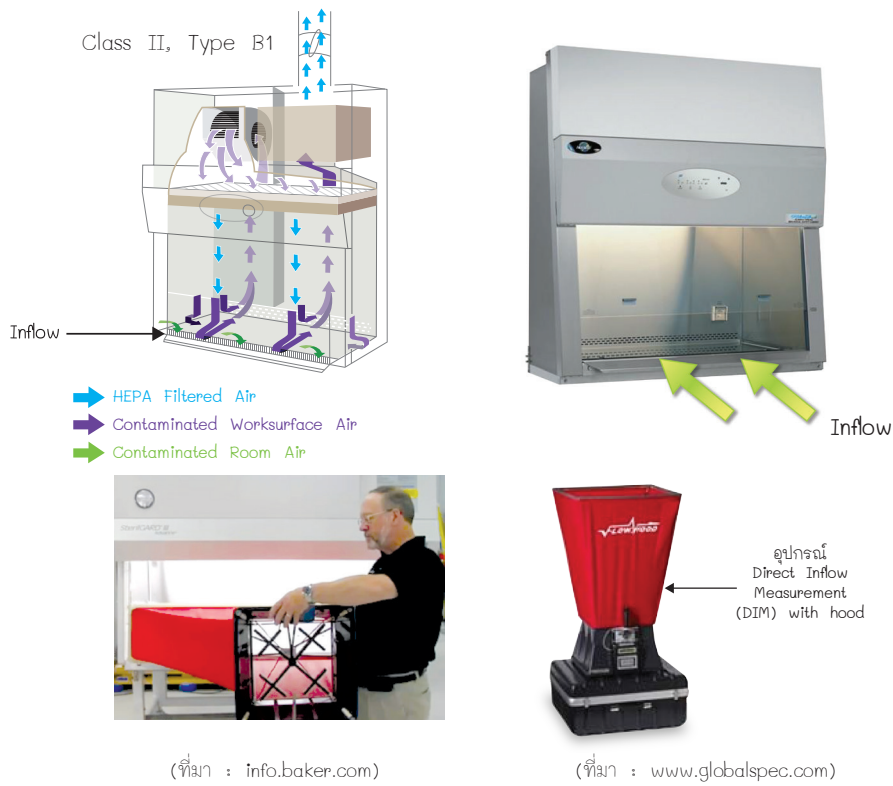
รูปที่ 28 แสดงทิศทางของ Inflow และ การวางอุปกรณ์ Dim with hood ครอบช่องหน้าต่างด้านหน้าตู้
