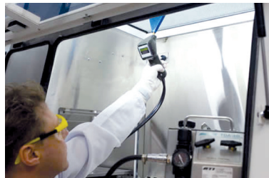
รูปที่ 36 การใช้อุปกรณ์ Aerosol photometer ในการตรวจหารอยรั่วของแผ่นกรอง HEPA (ที่มา : escoglobal.com )
