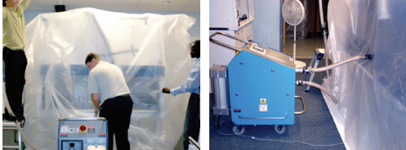
รูปที่ 37 Decon ตู้ BSC ด้วยวิธี Hydrogen peroxide vapor (ที่มา : bbs.sciencenet.cn)
