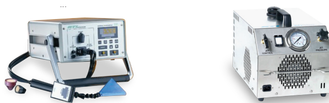
Aerosol photometer (ที่มา : www.hellotrade.com ) Aerosol generator (ที่มา : www.atitest.com ) รูปที่ 35 อุปกรณ์ใช้ในการตรวจ HEPA leak test
