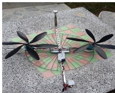
ภาพที่ 4 ชุดกังหันลมผลิตไฟฟ้าโดยใช้โครงจากเหล็ก
