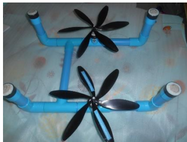
ภาพที่ 3 ชุดกังหันลมผลิตไฟฟ้าโดยใช้โครงจากท่อและข้อต่อ PVC
